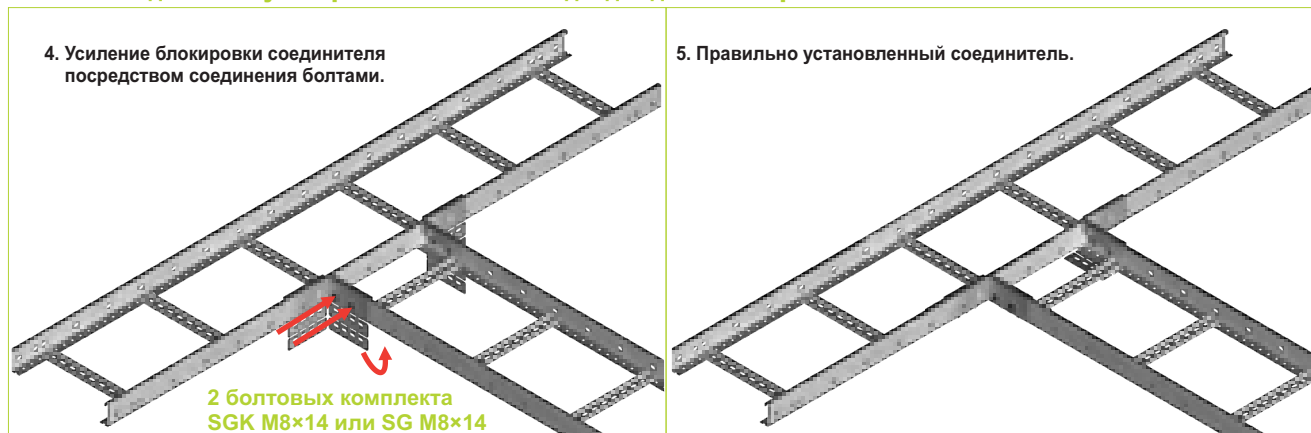
Пример монтажа приставного соединителя LDDKP2 с кабельростами, соединенными угловым соединителем LKUC2
