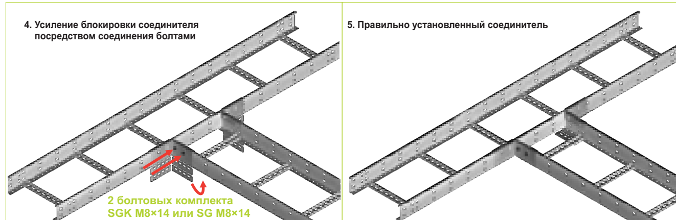
Пример монтажа приставного соединителя LDDKP1 с кабельростами, соединенными угловым соединителем LKUC1
