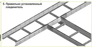
Пример монтажа приставного соединителя LDDKP1 с кабельростами, соединенными угловым соединителем LKUC1
