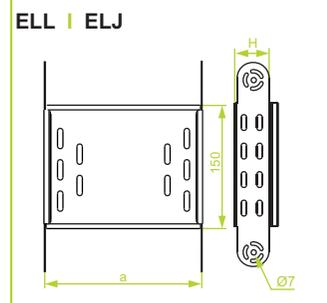
При монтаже шарнирных элементов используются болты SM M6×10.
